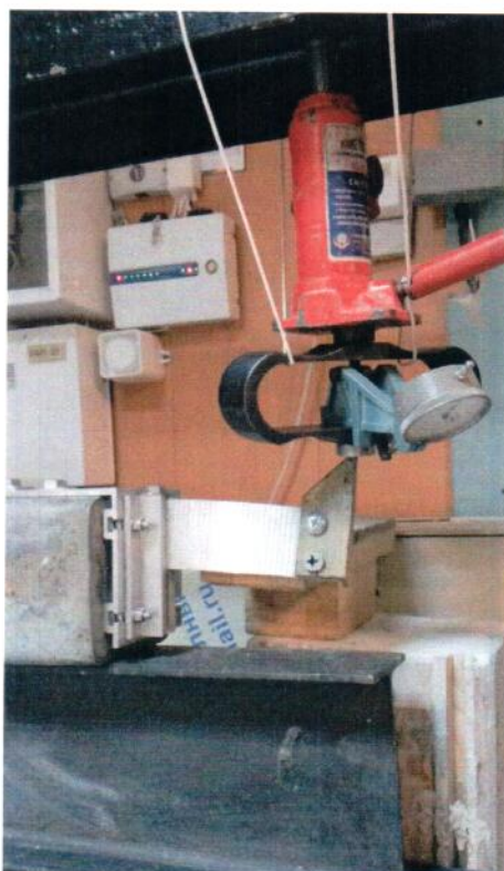
Фото 3. Положение образца под приложенной нагрузкой 203 кгс, кронштейн не разрушился.
